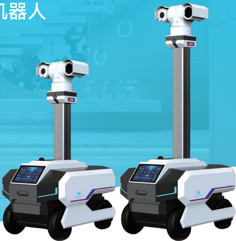
可伸缩支撑杆设计，高度1350-1750mm
